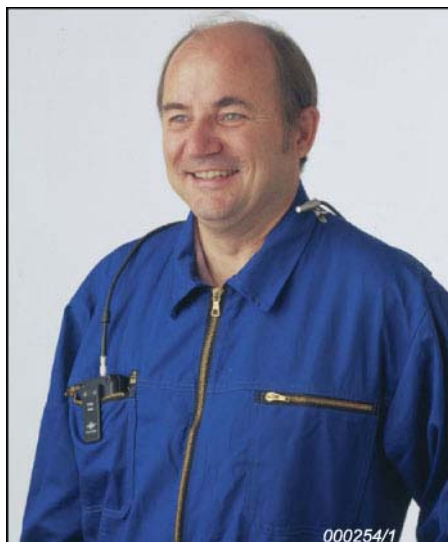
Рисунок 1. Микрофон может быть удобно закреплен на воротнике, а сам дозиметр может быть расположен в нагрудном кармане.
